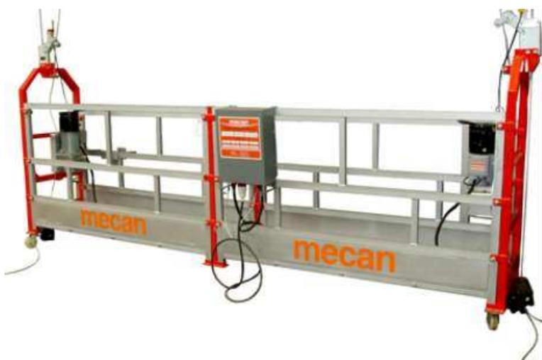
É constituído por uma plataforma, que possui guinchos instalados em cada cabeceira que realizam a movimentação através de cabos de aço. Nas extremidades da plataforma são instalados dispositivos trava-queda automáticos, que atuam na situação de ruptura do cabo de aço de sustentação ou quando ocorrer inclinação excessiva da plataforma.
