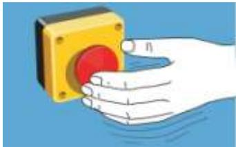
Botões de parada de emergência devem ser facilmente acessíveis e devem estar disponíveis em todos os modos de operação da máquina. Quando um botão é usado como um dispositivo de parada de emergência, deve ter a forma um cogumelo (ou palma da mão), na cor vermelha, com um fundo amarelo. Quando o botão é pressionado, os contatos devem mudar de estado, ao mesmo tempo o botão de bloqueio na posição pressionada.
