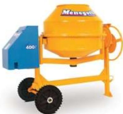
**Aplicação:** É um equipamento que foi projetado para trabalhar pesado na construção civil. Composta por um tambor com capacidade de mistura de até 310litros. O responsável pela movimentação do tambor é um motor (Elétrico/ Diesel/ Combustão), que é acionado por um sistema de engrenagem Movidá/ Motora com correias em "V". O sistema de descarga é manual.
