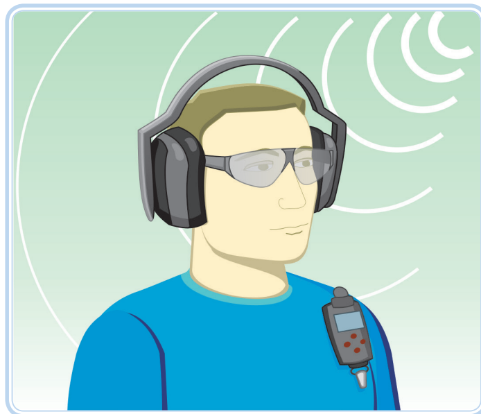
Figura 3.5: Trabalhador portando um dosímetro de ruído
