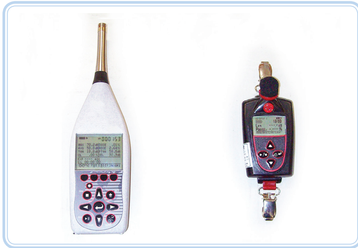
Figura 3.3: Medidor de nível de pressão sonora integrador com filtro para bandas de frequência e dosímetro de ruído
