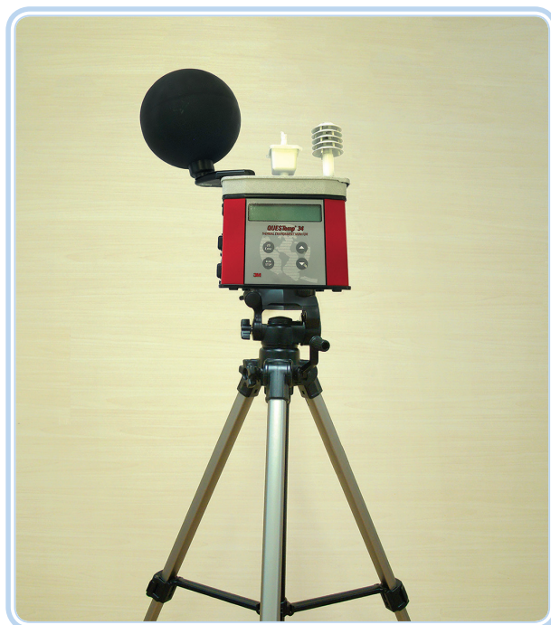
Figura 7.2: Monitor de estresse térmico (IBUTG)
