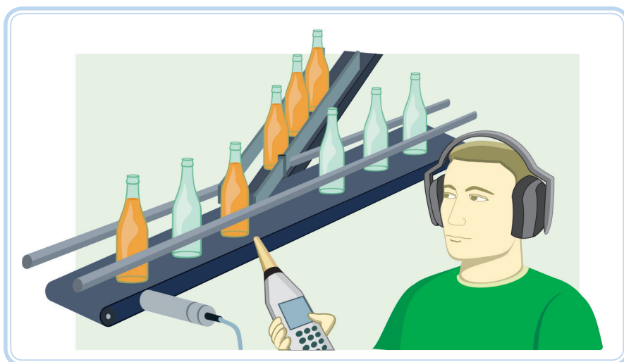
Figura 3.4: Avaliação do ruído com decibelímetro
